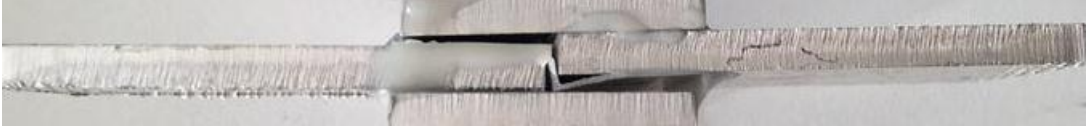
Şekil 4.6. AA-5083 Alüminyum yama ile yamalanmış çekme numunesinin çekme deneyi sonrası yandan görünüşü
