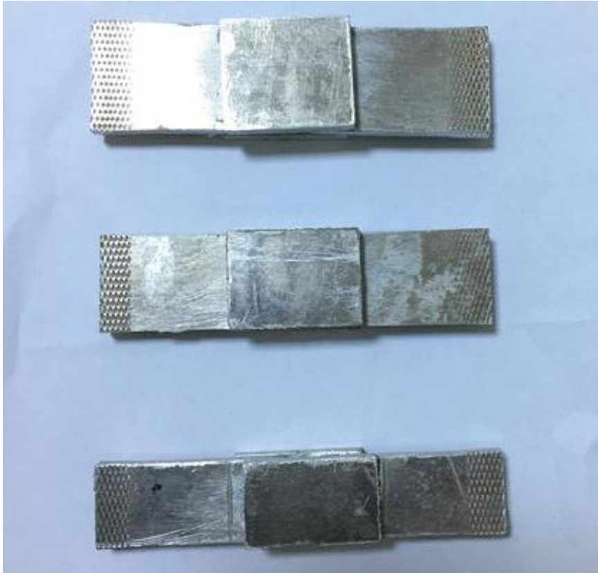
Şekil 4.5. AA-5083 Alüminyum yama ile yamalanmış çekme numunesinin çekme deneyi sonrası üstten görüşleri
