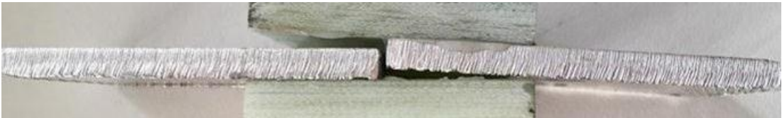
Şekil 4.8. Cam Elyaf Takviyeli Kompozit Malzeme(EP GC 201) yama ile yamalanmış çekme numunesinin çekme deneyi sonrası yandan görünüşü
