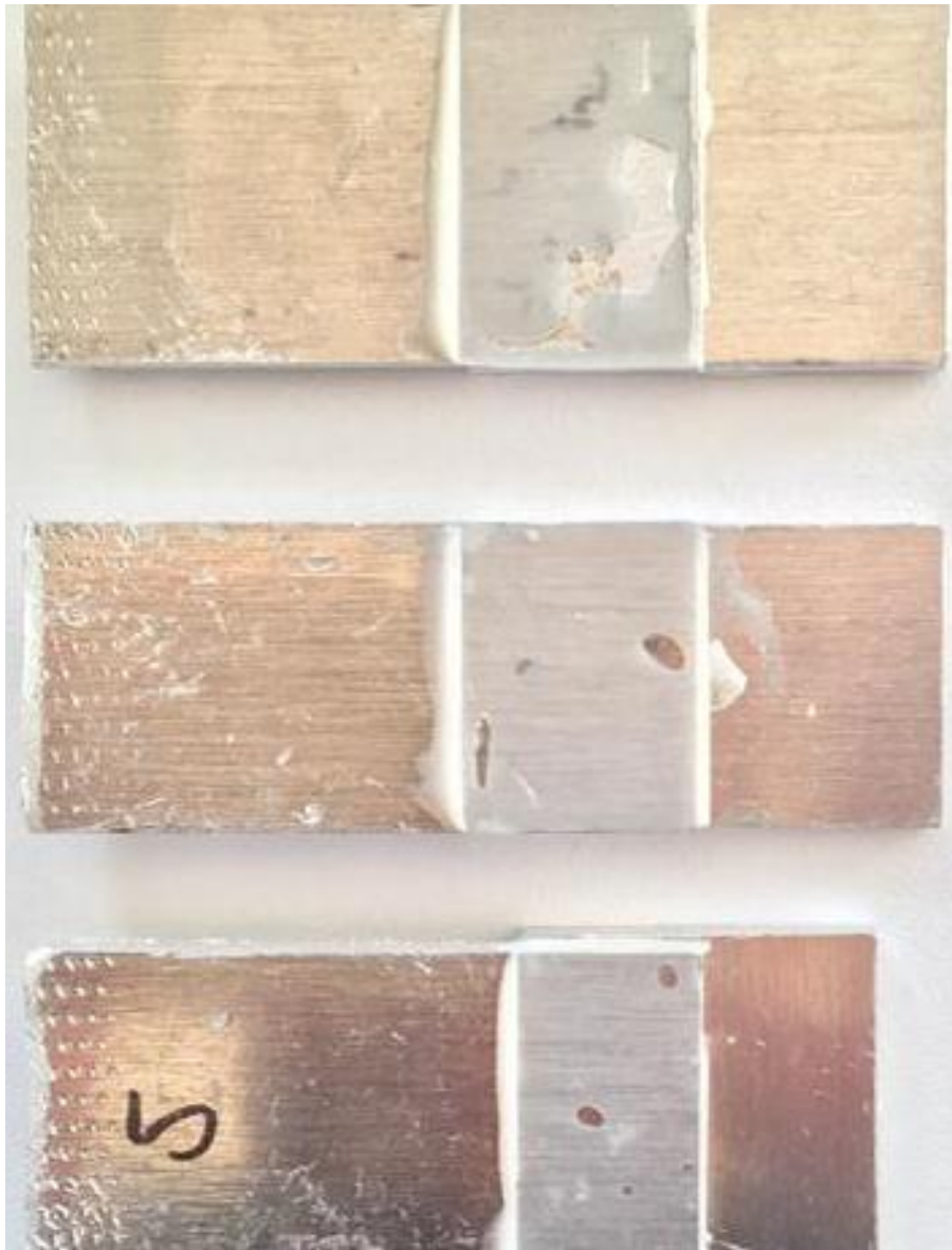
Şekil 4.9. AA-5083 Alüminyum ana ve yama numunelerinde oluşan hasarlar
