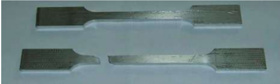
Şekil 3.1. ASTM370 standartına göre AA2024-T3 çekme numunesi
