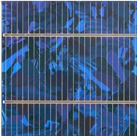
Şekil 4.3. Polikristal Hücre Yapısı ve Teknik Verileri
