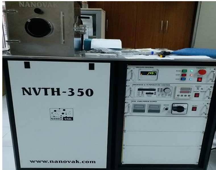
Şekil 2.8. Termal buharlaştırma sistemi (Batman Üniversitesi)
