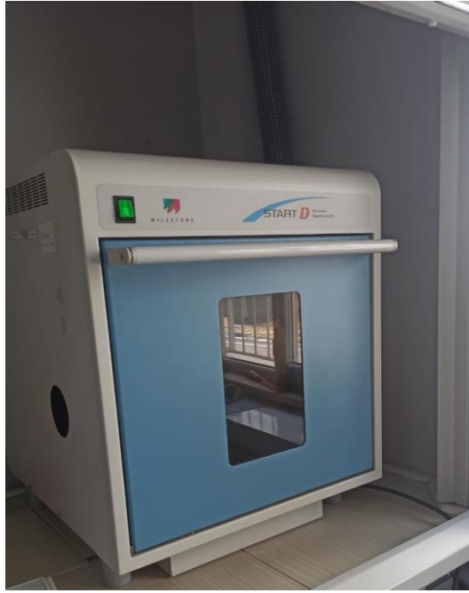
Şekil 3.5. Milestone Start D mikrodalga fırın ünitesi
