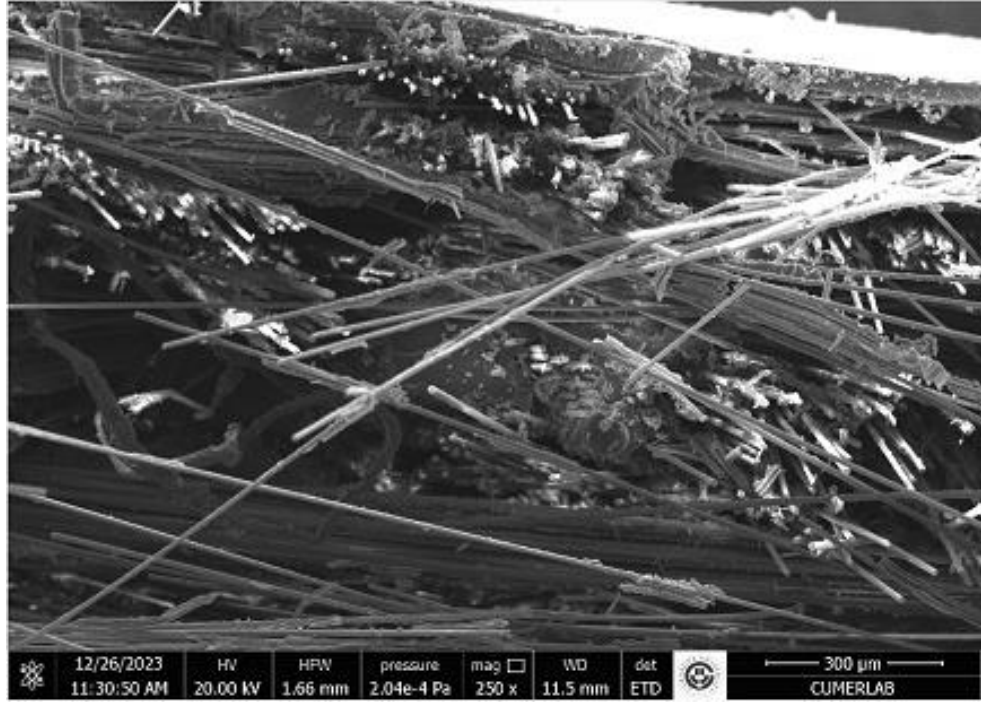
Şekil 4.29. Al 2 O 3 mikropartikül takviyeli kompozitlerde fiber demetleri hasar mekanizmaları
