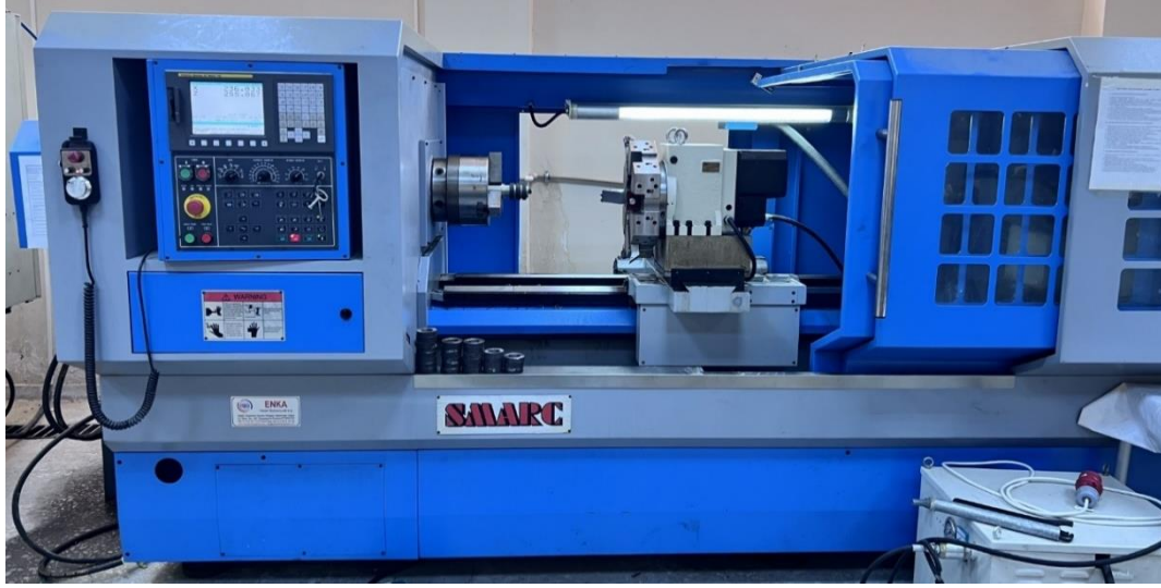
Şekil 6. 2. SMARC marka CAK6166B X200 model torna tezgâhı.
