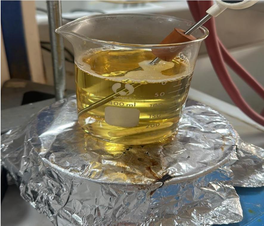
Şekil 3.5. Transesterifikasyon sonucu elde edilen ester
