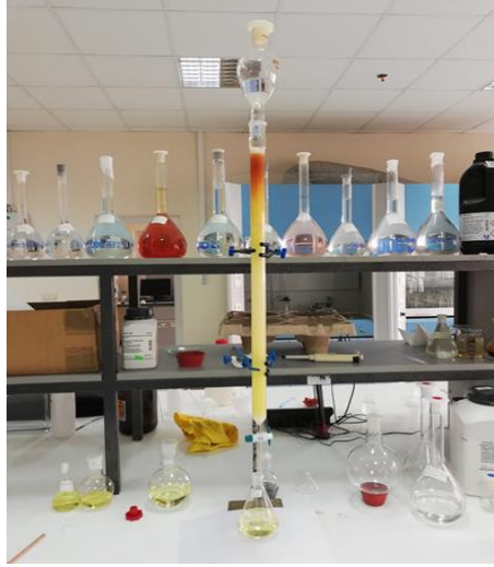
Şekil 3.2.Uygulanan kolon kromatografisinin görüntüsü
