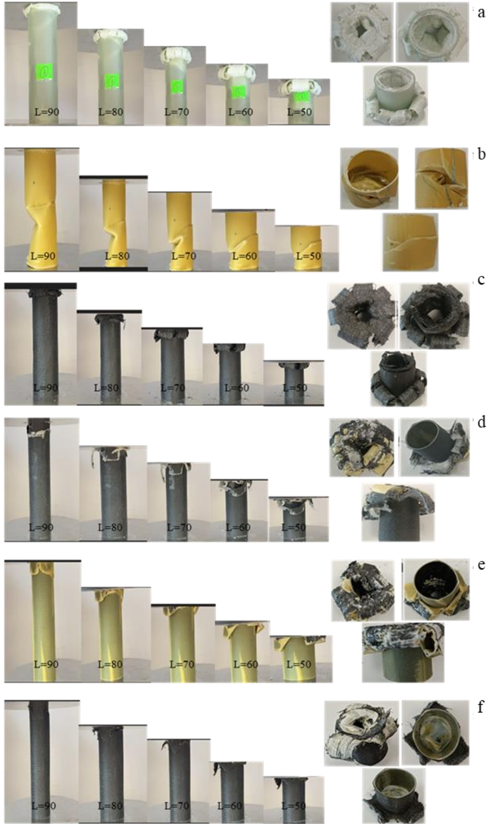
Şekil 4.3. S1-S6 numunelerinin deney sırasında ki değişimi ve nihai ezilmiş şekilleri: a) GFRP b) AFRP c) CFRP d) ACGFRP e) CGAFRP e) GACFRP
