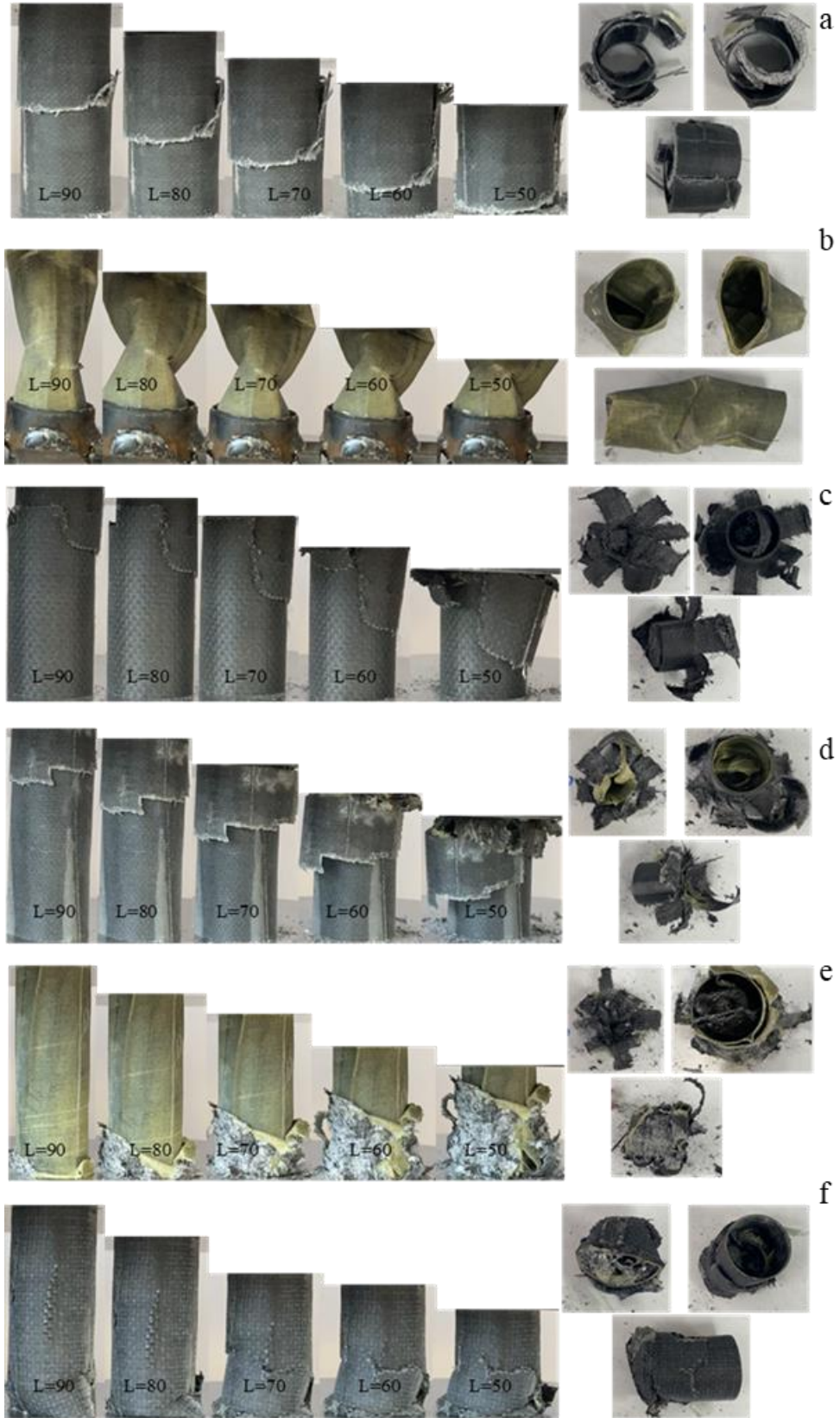
Şekil 4.19. S25 – S30 numunelerinin deney sırasında boy değişimi ve nihai ezilmiş son şekilleri: a) GFRP %0,25GNP H500 b) AFRP %0,25GNP H500 c) CFRP %0,25GNP H500 d) ACFRP %0,25GNP H500 e) GACFRP %0,25GNP H500 f) CGFRP %0,25GNP H500
