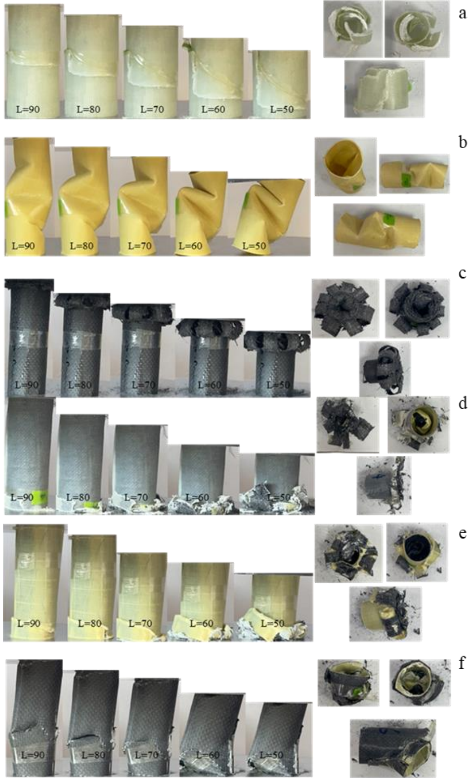
Şekil 4.15. S19 – 24 numunelerinin deney sırasında boy değişimleri ve nihai ezilmiş son şekilleri: a) GFRP H500 b) AFRP H500 c) CFRP H500 d) ACGFRP H500 e) CGAFRP H500 e) GACFRP H500
