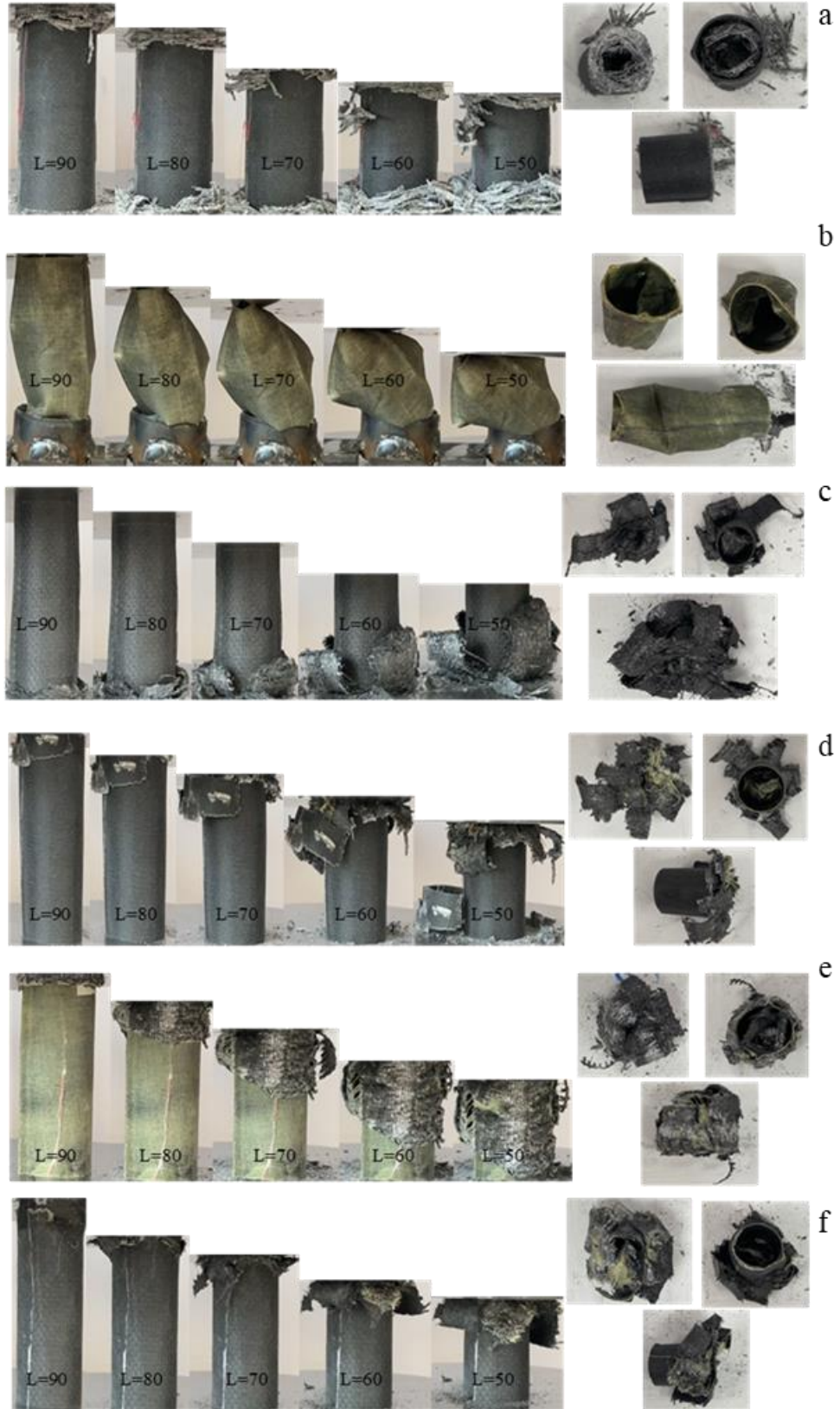
Şekil 4.35. S49 – S54 numunelerinin deney sırasında boy değişimi ve nihai ezilmiş son şekilleri: a) GFRP %0,50 GNP H1000 b) AFRP %0,50GNP H1000 c) CFRP %0,50GNP H1000 d) ACGFRP %0,50GNP H1000 e) CGAFRP %0,50GNP H1000 e) GACFRP %0,50GNP H1000
