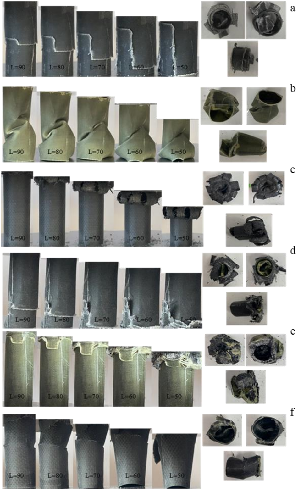
Şekil 4.7. S7 – 12 numunelerinin deney sırasındaki boy değişimleri ve nihai ezilmiş son şekilleri: a) GFRP %0,25GNP b) AFRP %0,25GNP c) CFRP %0,25GNP d) ACGFRP %0,25GNP e) CGAFRP %0,25GNP e) GACFRP %0,25GNP
