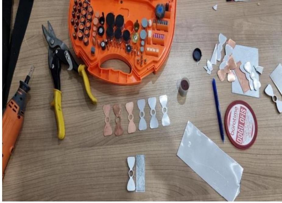
Şekil 2.20. Farklı malzemelerden üretilmiş türbülator kanatçıkları (Demiray, 2022)
