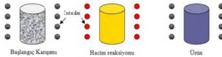
Şekil 2.3. Termal patlama veya eş zamanlı yanma (Altınordu, 2012).
