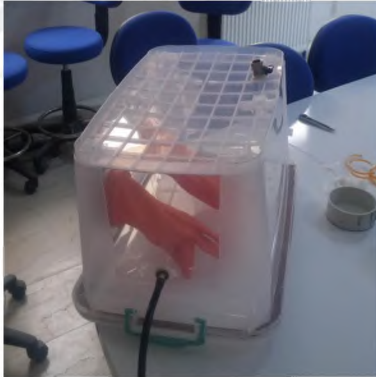
Şekil 3.2. Hazırlanan basit eldivenli kabin düzeneği
