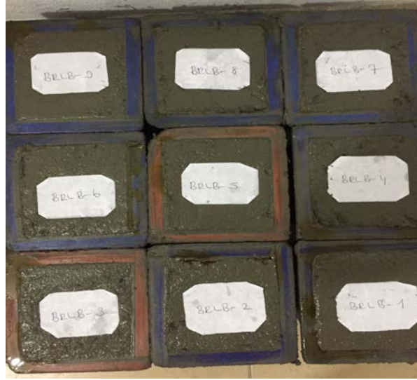
Şekil 3.10. Bazalt agregalı lifli referans betonların (BRLB) kalıplara yerleştirme sonrası görünümü
