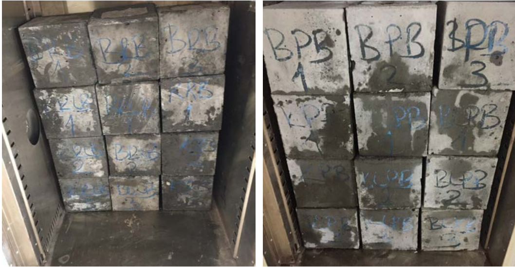
Şekil 3.18. Beton numunelerin etüv içerisindeki görünümü
