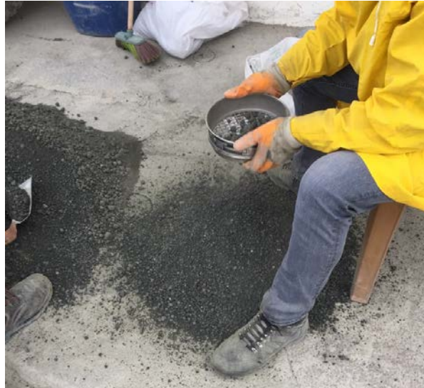
Şekil 3.19. Beton üretimi için numune eleme işlemleri
