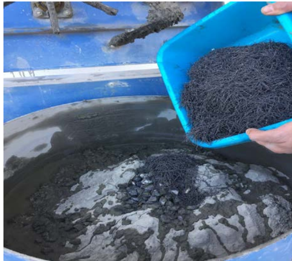
Şekil 3.7. Bazalt agregalı lifli referans betonun (BRLB) mikser içerisindeki görünümü
