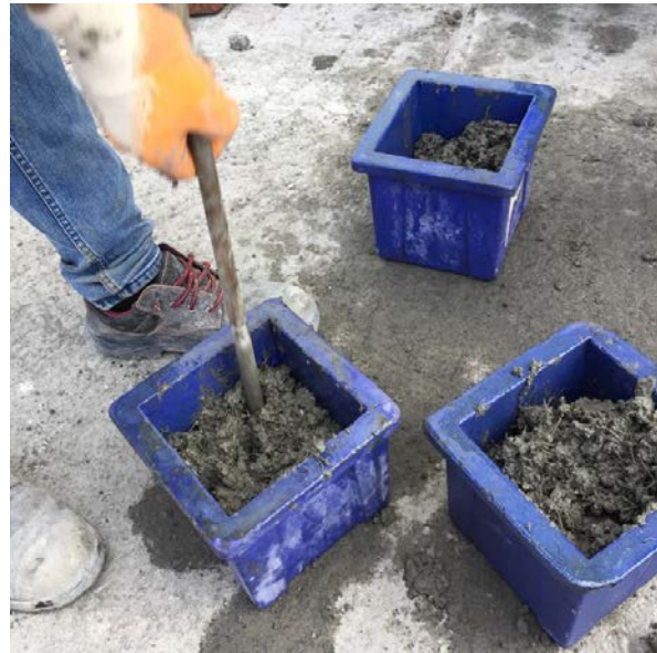
Şekil 3.9. Bazalt agregalı lifli referans betonun (BRLB) kalıplara dökülmesi ve şişlenerek sıkıştırılması
