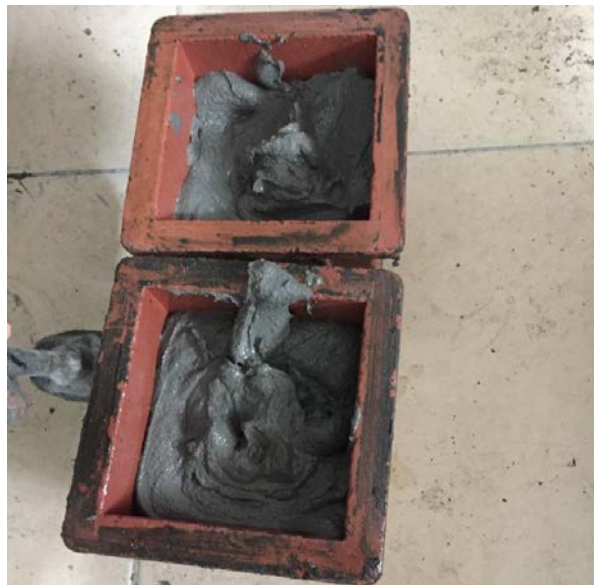
Şekil 3.14. Bazalt agregalı lifsiz pudra betonun (BPB) kalıp içerisindeki görünümü
