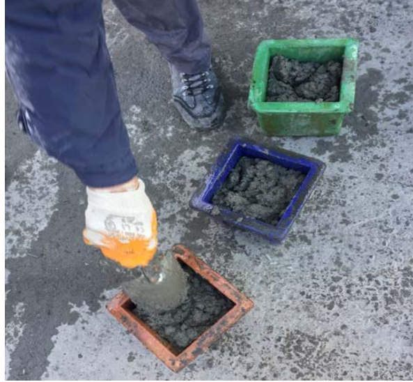
Şekil 3.21. Basınç deney numunelerinin kalıplara yerleştirilmesi
