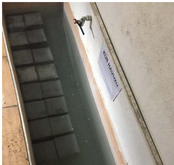
Şekil 3.17. Beton numunelerin kür havuzundaki görünümü
