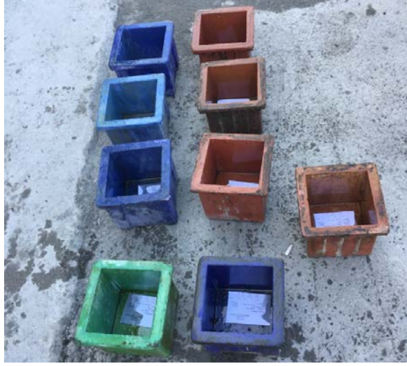
Şekil 3.20. Beton numune kalıp görünümü
