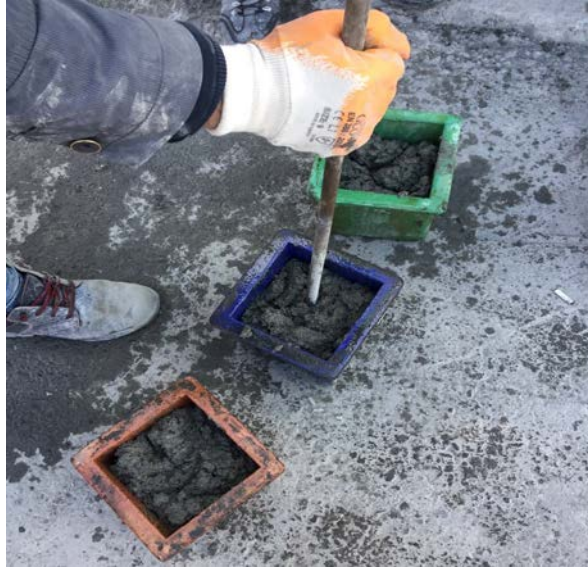
Şekil 3.22. Beton basınç deney numunelerinin kalıp içerisinde sıkıştırılması
