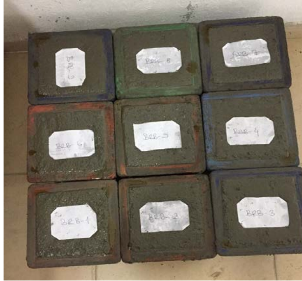
Şekil 3.5. Kalıplara dökülmüş bazalt agregalı lifsiz referans beton (BRP) numuneleri
