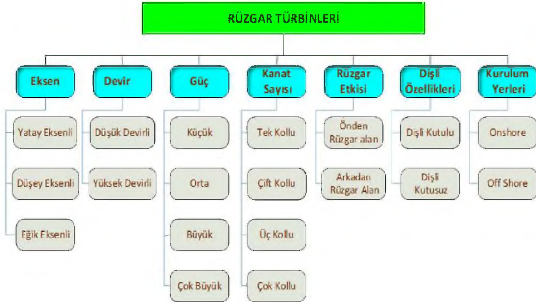
Şekil 3.4 Rüzgâr türbinlerinin sınıflandırılması.
